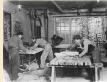
Il Cav. Sebastiano Navello (a destra) sta leggendo dei progetti di costruzione di serramenti; sulla sinistra alcuni operai stanno passando alla macchina "Toupie" un serramento per eseguire la "squadatura" del battente (1940)
