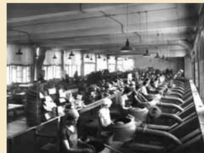
Reparto di lavorazione nello stabilimento Borsalino: rasatura del cappello (1934) Foto Paganini
